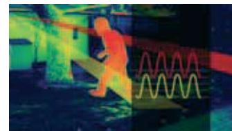
Gecorreleerd signaal in beide kanalen = PIR alarm
