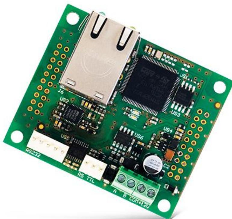
Le SAF-CSP-ETH est un module de communication conçu pour visualiser à distance l'écran de la centrale d'incendie SAF-CSP-204 ou SAF-CSP-208. Via un réseau, la centrale est affichée sur l'écran du PC au moyen d'un navigateur et d'une connexion Internet.
