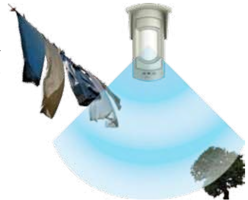
Avec la fonction SCP active : les signaux des 2 PIR ne sont pas homogènes, l'alarme n'est pas créée.
