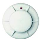
Le détecteur optique ECO1003 est équipé d'une chambre de mesure optique et d'un ASIC (Application Specific Integrated Circuit). La combinaison de la conception unique de la chambre de mesure et d'autres caractéristiques techniquement sophistiquées prolonge l'intervalle d'entretien, avant de devoir passer au nettoyage du détecteur.
