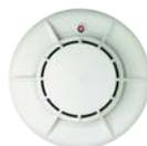
Le détecteur multicritères ECO1002 dispose d'une chambre de mesure optique et d'une sonde thermique classe A1R, combiné avec un microprocesseur et des algorithmes sophistiqués. La combinaison de caractéristiques optiques et thermiques accélère la réponse lors des situations d'incendie réelles, tandis que le risque de fausses alarmes, causées par l'environnement, est limité au strict minimum.
