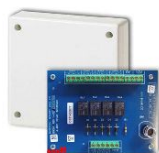
Carte interface universelle à 4 relais sous boîtier pour GalaXy • Alimentation : 8.5 à 16V • Résistance : 280 Ohms (42mA) • Tension contact max. 125 VAC / 150 VDC
