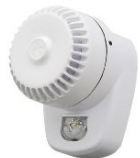
Sirène Roshni blanc avec flash led blanc pour montage mural, 32 tonalités, 102dB, 18-28VDC, 22-37 mA, IP65, conforme EN54-3 et EN54-23, couverture flash W-2,4-7,5, fréquence 0,5 ou 1 Hz, L95mm x H135mm x P95mm.
