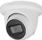
• Caméra turret IP • J/N • 5MP • 2.8mm (111°) • IR50M • AI • 5MP/25ips • H265/H264 • WDR 120dB • Slot pour carte mémoire (max. 512GB) • I/O • Audio micro • IVS • PoE/ EPoE • IP67 • Accessoires optionnels: PC95JUNC-2, PC95WALL-MINI5
