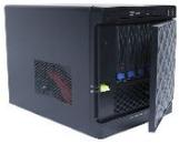
Workstation Client Securelogiq • Stockage: 250Gb SSD • Qube • Jusqu'à 144 flux CIF • Mémoire: DDR4 16Go • 1 Ports Gigabit Ethernet RJ-45 • Processeur: Intel Core i7-12700 • GPU: Nvidia Quadro P1000, 4Gb, 4 x Mini Display port • Windows 10 64bit • Garantie: 3 ans sur site-extensible • Alim: 100 à 240 VAC 50-60Hz 430W max. • Clavier USB-souris USB-cordon d'alimentation-4 adaptateurs mDP vers DP-4 adaptateurs mDP vers HDMI • 280x211x241
