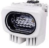
Angle du faisceau (horizontal) : 30° ~ 10 • Distance : 150 ~300m • Modèle de faisceau : Elliptique • Réseau de LED : 18 pcs LED haute puissance • Consommation d'énergie : 48W • Longueur d'onde : 850nm • Entrée numérique : Contrôle IR ON/OFF • Sortie numérique : Capteur de lumière • Connecteur : ITB Touch Board du boîtier série P6 • Température de fonctionnement : -40 °C ~ 50 °C
