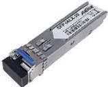
Module SFP industriel BiDi 1 Gbps • TX: 1310nm - RX: 1550nm • Température de fonctionnement: -40°C et 85°C • Voltage: 3,3V • Transmission: 9/125µm jusqu'à 20 Kms • Connecteur: Simplex LC • Certification: IEC 825,EN60825-1,FDA 21 CFR 1040.10 and 1040.11
