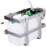
Construction : Réservoir en polyéthylène, cage en acier inoxydable • Dimensions : 405.5 x 194 x 267 (mm) • Capacité du réservoir d'eau : 10L • Température de fonctionnement : 0 °C ~ 60 °C • Type de montage : Montage mural / Montage sur poteau
