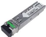
Module SFP industriel BiDi 1 Gbps • TX: 1550nm - RX: 1310nm • Température de fonctionnement: -40°C et 85°C • Voltage: 3,3V • Transmission: 9/125µm jusqu'à 20 Kms • Connecteur: Simplex LC • Certification: IEC 825,EN60825-1,FDA 21 CFR 1040.10 and 1040.11
