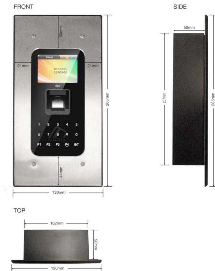
Ce boîtier permet d'encastrer les lecteurs d'empreintes digitales VIR-AC5000. Le boîtier est réalisé en aluminium et peint en noir (Powder Coating). La face avant est en acier inoxydable brossé.
